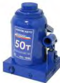
1659 Домкрат гидравлический 50т h=255-470 мм МАЯКАВТО™
