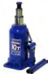
Домкрат гидравлический телескопический 10т h=225-565 мм МАЯКАВТО™
